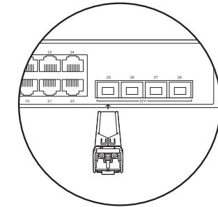
光模块分别插入交换机的SFP插槽
